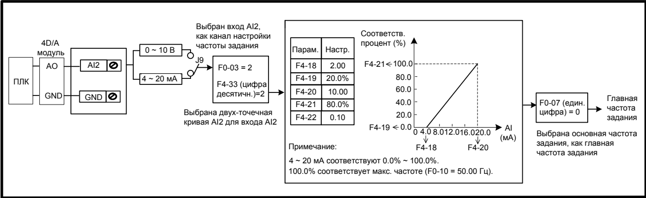
Рисунок 6-17 Входной ток AI2 для управления частотой задания
